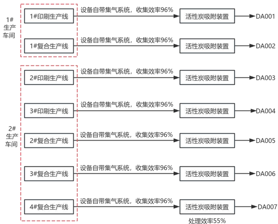
图 3-1 变动前废气收集处置示意图
